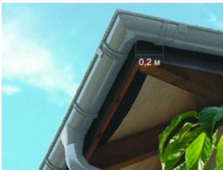
9. Поворотный угол крепится между двумя крайними держателями. Максимальное расстояние между держателями и поворотом лобовой доски – 0,2 м.
