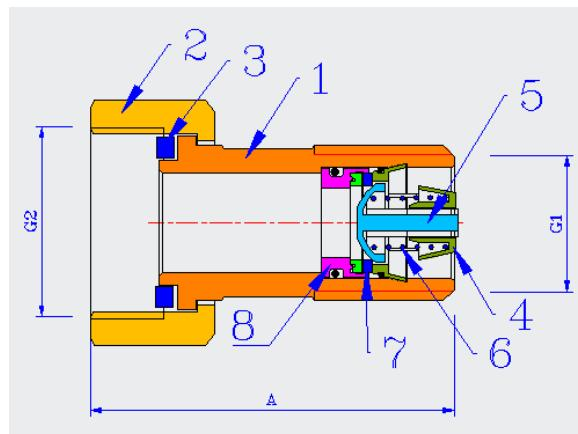
В канал напівзгону вставлений зворотний клапан, який складається з нейлонового корпусу 4, штока з золотником 5 і пружини 6 з нержавіючої сталі AISI 316. Вузол сідла складається з нейлоновою сідельній обойми 8 і сідла 7 з тефлону.
